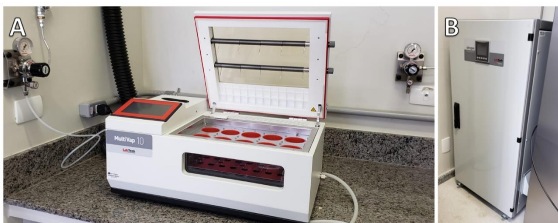
Figura 1. Concentrador de Amostras Multivap 10 (A) e gerador de nitrogênio LN40 (B) instalados no Laboratório AQQUA.
